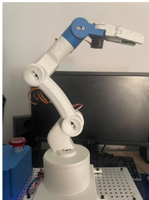
Σχήμα 67: Το τελικό αποτέλεσμα εκτύπωσης του ρομποτικού βραχίονα
