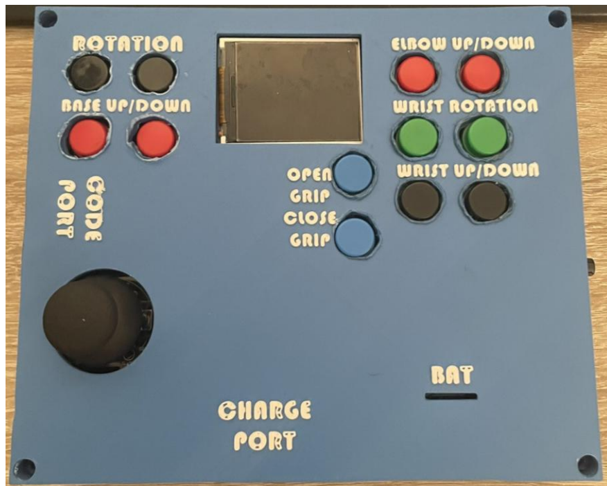
Σχήμα 53: Η κάτοψη της τελικής δομής του χειριστηρίου με το πάνω μέρος
