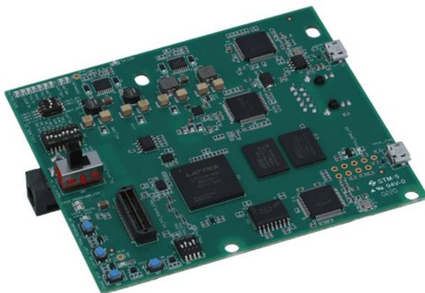
Εικόνα 5 Παράδειγμα πλακέτας FPGA
