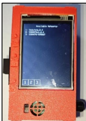
Εικόνα 138: Σκανάρισμα διαθέσιμων Wi-Fi δικτύων
