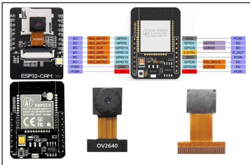
Εικόνα 19: ESP32 CAM Pinout
