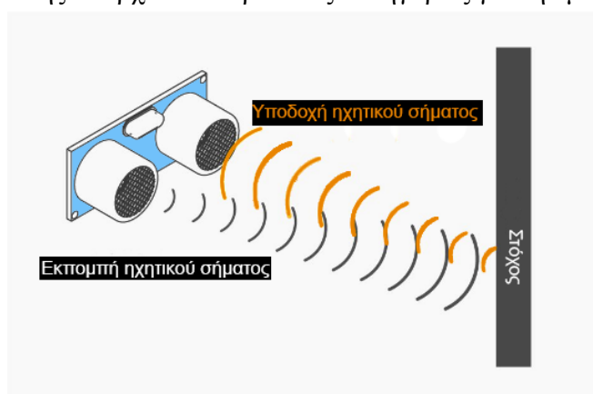
Εικόνα 33: Τρόπος λειτουργίας αισθητήρα υπερήχων
