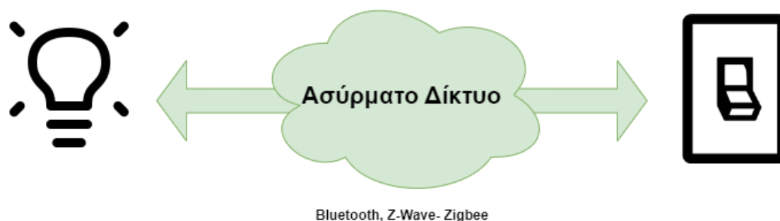
Εικόνα 8: Παράδειγμα από το μοντέλο επικοινωνίας Συσκευή προς Συσκευή (Device to Device)
