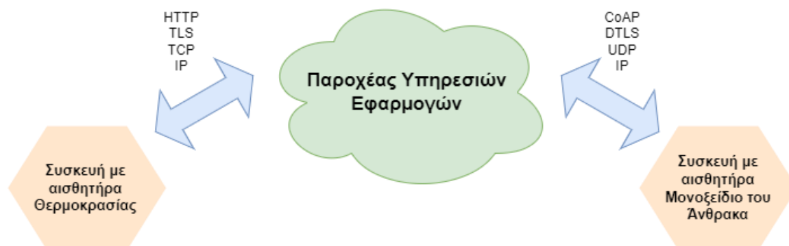
Εικόνα 9: Παράδειγμα από το μοντέλο επικοινωνίας Συσκευή προς Νέφος (Device to Cloud)
