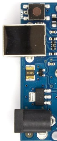
Εικόνα 29: Διακόπτης RESET, θύρα USB και βύσμα τροφοδοσίας
