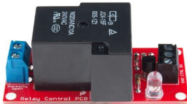
Εικόνα 36: Το Beefcake Relay Kit συναρμολογημένο
