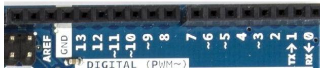
Εικόνα 28: Ψηφιακοί ακροδέκτες εισόδου/εξόδου, γείωσης και τάσης αναφοράς
