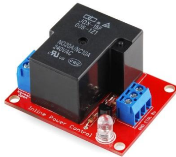
Εικόνα 34: Ρελέ για τον έλεγχο της κλειδαριάς
