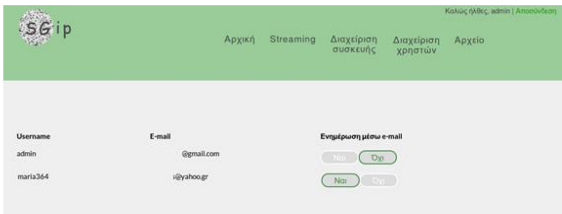
Εικόνα 82: Λίστα χρηστών για ενημέρωση. Ο διαχειριστής μπορεί να επιλέξει ποιοι από τους χρήστες θα λαμβάνουν κάθε φορά ενημερωτικό e-mail σε περίπτωση εισβολής κάποιου άγνωστου ατόμου στο χώρο φύλαξης του συστήματος.
