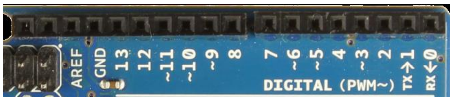
Εικόνα 24: Ψηφιακά pins εισόδου / εξόδου Arduino UNO.
