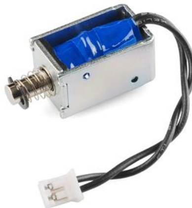
Εικόνα 93: Ηλεκτρονικό έμβολο (solenoid) που χρησιμοποιήθηκε. Το έμβολο αυτό συνδέεται με τα κατάλληλα ηλεκτρονικά μέσα που αναφέρονται στην επόμενη ενότητα, ώστε με το κατάλληλο ρεύμα να συμπιέζεται και να αποσυμπιέζεται εγκαίρως.
