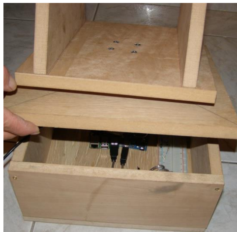
Εικόνα 89: Πρώτη και δεύτερη βάση στήριξης της κατασκευής. Στην εικόνα φαίνεται και το άνοιγμα του πάνω μέρους της πρώτης κύριας βάσης.
