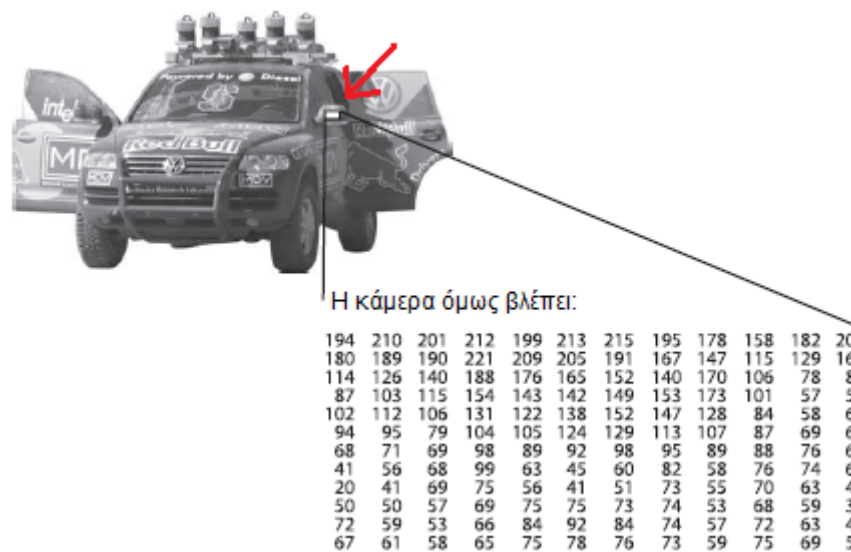
Εικόνα 33: Η εικόνα ενός αυτοκινήτου όπως γίνεται αντιληπτή από την όραση μηχανής. Οι αριθμοί που αντιλαμβάνεται το σύστημα αντιστοιχούν σε διάφορες συνιστώσες του αντικειμένου το οποίο απεικονίζεται, στην παρούσα εικόνα τον καθρέπτη του αυτοκινήτου.
