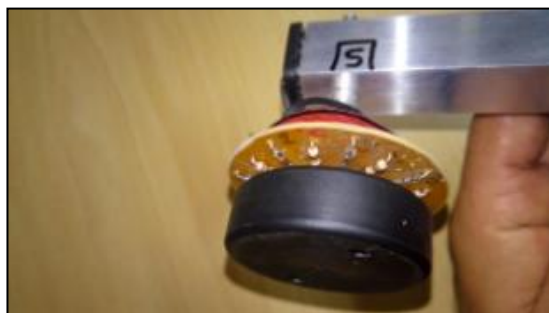
Εικόνα 38: Διάταξη αυτοσχέδιου ανεμοδείκτη 56
