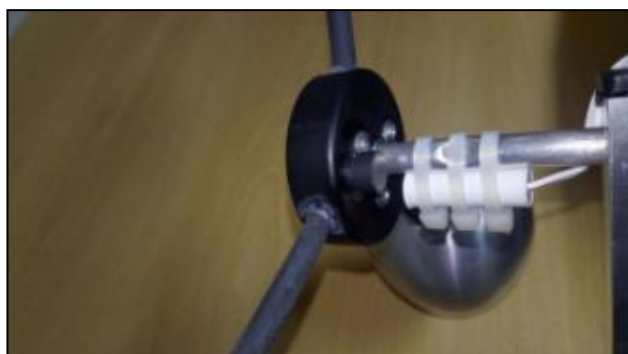
Εικόνα 35: Ιδιοκατασκευή αισθητήρα ταχύτητας ανέμου 49
