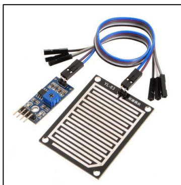
Εικόνα 15: Ο αισθητήρας FC-37 25
