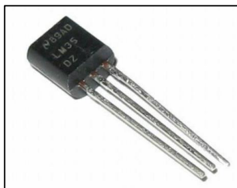
Εικόνα 10: Ο αισθητήρας LM35 19
