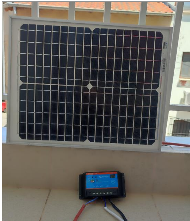
Εικόνα 78: Συνδέσεις σε PWM Controller
