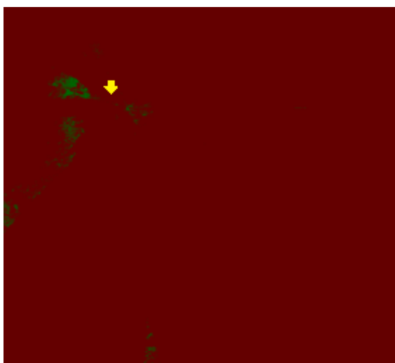
Σχήμα 43 Αποτέλεσμα της ανάλυσης οπτικού πεδίου, όπου με πράσινο απεικονίζονται τα κελιά που είναι ορατά από τον παρατηρητή, με κόκκινο απεικονίζονται τα κελιά που δεν είναι ορατά, και ο παρατηρητής βρίσκεται στο σημείο που δείχνει το κίτρινο βέλος.
