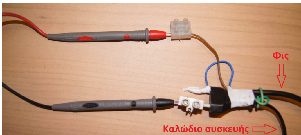
Εικόνα 45: Σύνδεση καλωδίων και ακίδων αμπερόμετρου
