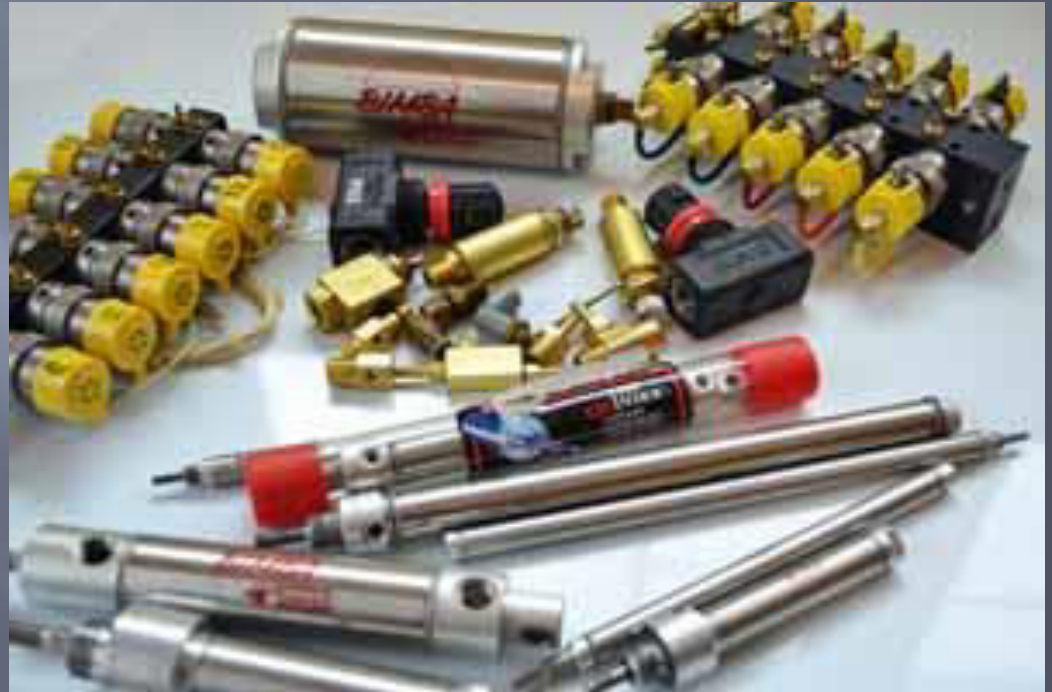
Διάφοροι πνευματικοί κύλινδροι που χρησιμοποιούνται στην κίνηση των animatronics
